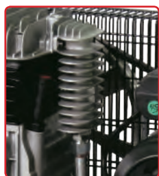
1 Collettore di raffreddamento.
